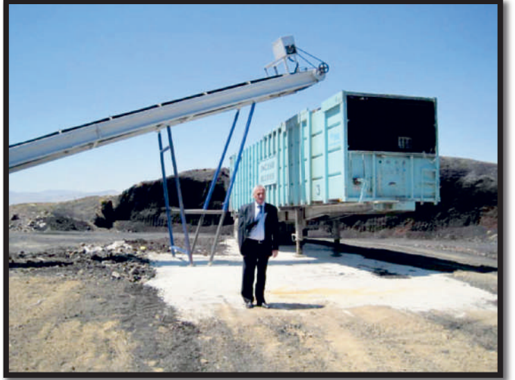
Atıkların çöp silosuna yüklemesinin rahat yapılabilmesi için transfer bandı yapıldı.
