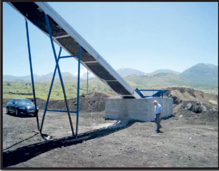
Atıkların çöp silosuna yüklemesinin rahat yapılabilmesi için transfer bandı yapıldı.
